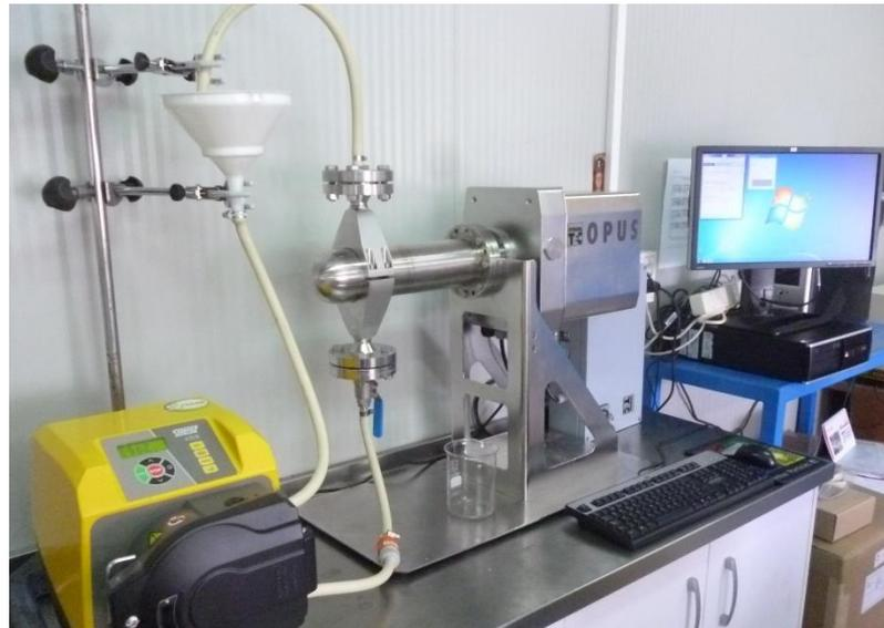
**Figura 16. Montaje sobre poyata para pruebas con la sonda OPUS de Sympatec.**
