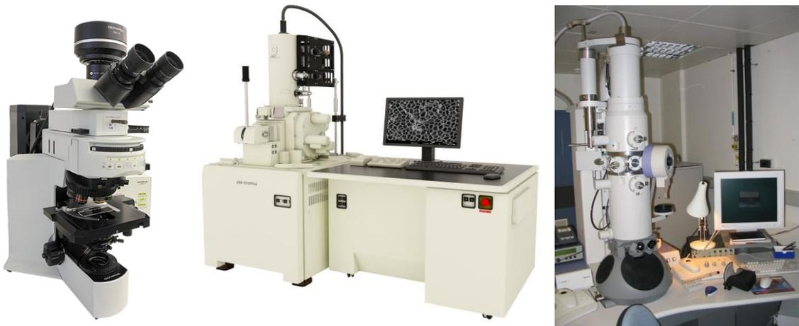
**Figura 7. Distintos tipos de microscopios (óptico, electrónico de barrido y electrónico de transmisión).**
