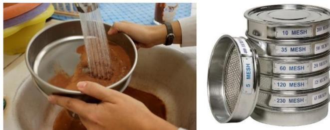
Figura 1. Medida de rechazo en húmedo en tamiz y batería de tamices. (Fuente: ITC)
